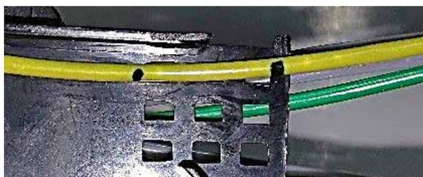
2- Posicione o(s) Tubo(s) Loose(s) que será(ão) utilizado(s) na bandeja e faça 02 marcas em todos os tubos loose que serão utilizado
